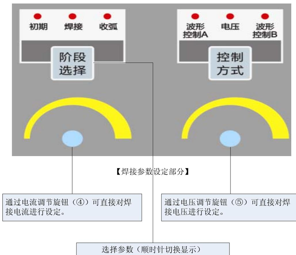
用阶段选择键(⑦)选择调整参数。数字显示管的显示自动改变为对应被选的参数值，同时对应各参数的LED亮灯。
