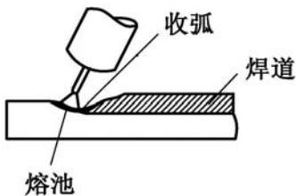
在焊接结束部位有残留凹陷。因为凹陷会引发裂纹或焊接缺陷，所以要尽量使其变小，这种处理称为收弧填弧坑。
